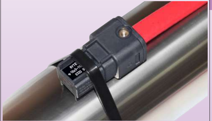
电缆插入拧紧并安装在管道上
